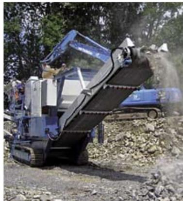
Der Vorebrecher zerkleinert das Gestein auf eine Grösse von 0-250 mm. So wird es in den Schacht geschuttet.
