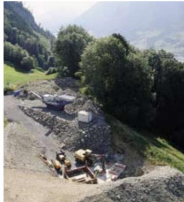
Das Abbaugelände Rüti. Hinten der Vorebrecher, vorne die Schutzkonstruktion mit dem Abwurfschacht.
