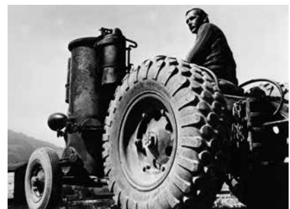
Zeichen des Krieges: Das Öl war während dieser Zeit rar. Deshalb standen Holzgas-traktoren im Einsatz.
